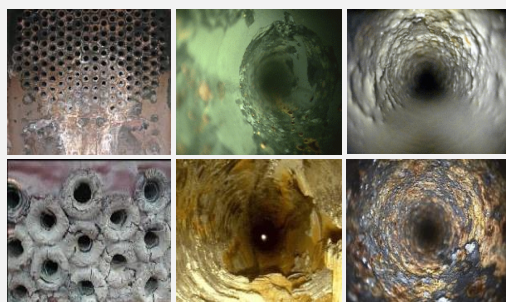
Imagen de las Incrustaciones en la tubería de los condensadores ocasionados por los carbonatos, sales, metales y microorganismos presentes en el agua.
